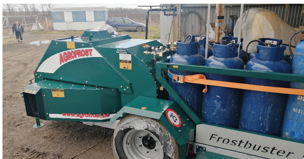
■ Слика 21. Машина за загревање ваздуха
